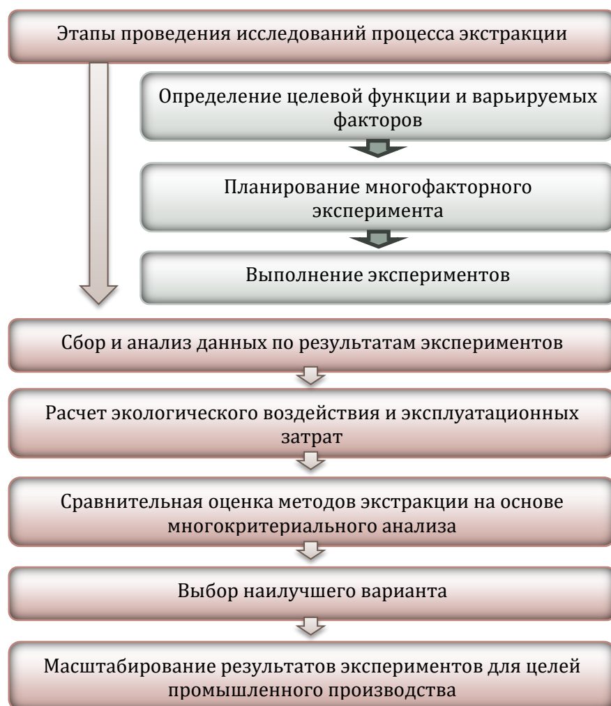
Рисунок 6 – Методология комплексного исследования экстракции с учетом технологических, экономических и экологических аспектов
