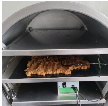
Рисунок 1 – Сушка моркови (слева) и яблок (справа) низкотемпературным вакуумным методом в вакуумной камере установки Hetosicc
