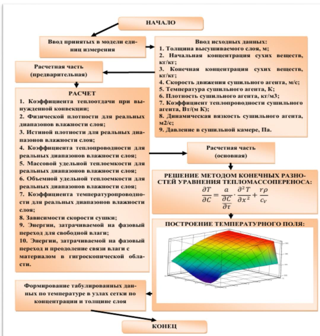
Рисунок 3 – Блок-схема определения эволюции температурных полей в объекте сушки
