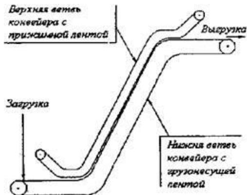
Рис. 1. Проектная схема крутонаклонного конвейера
