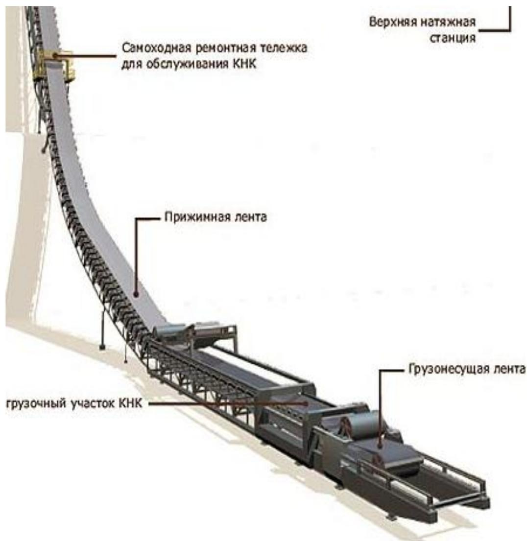
Рис. 2. Крутонаклонный конвейер
