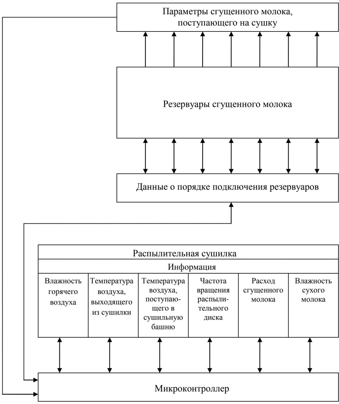
Рис. 2. Структурная схема стабилизации сухих молочных продуктов по влажности
