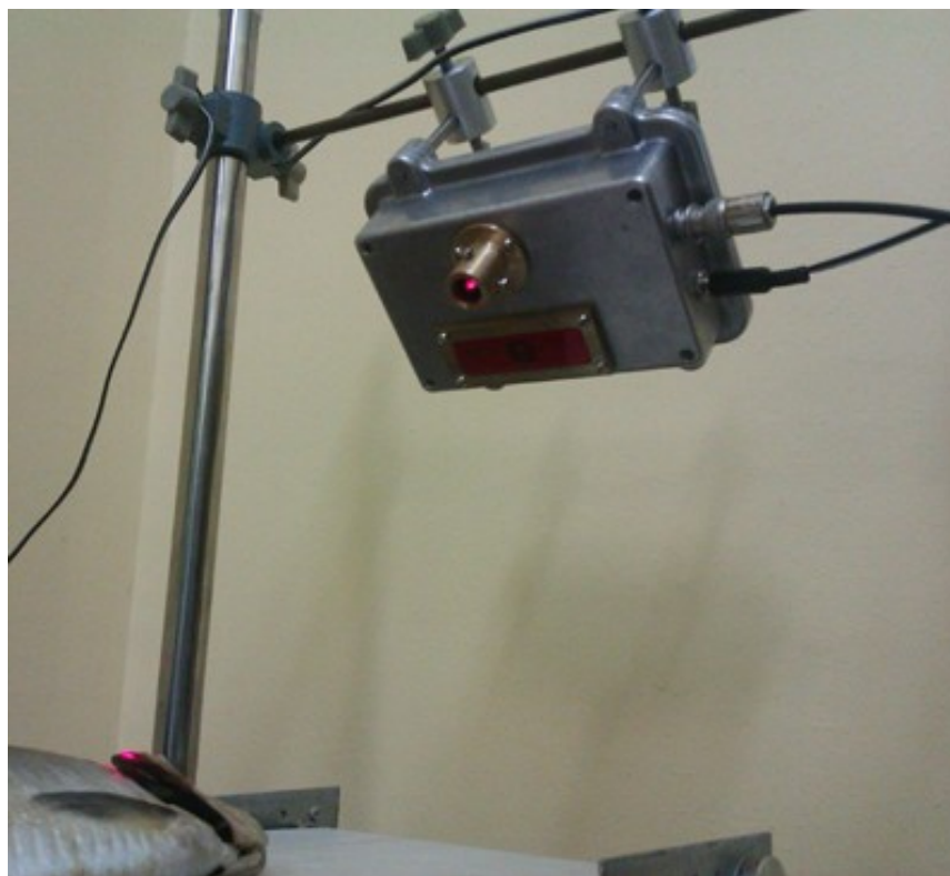
Рис. 3. Измерение морфометрических параметров рыбы лазерным локатором
