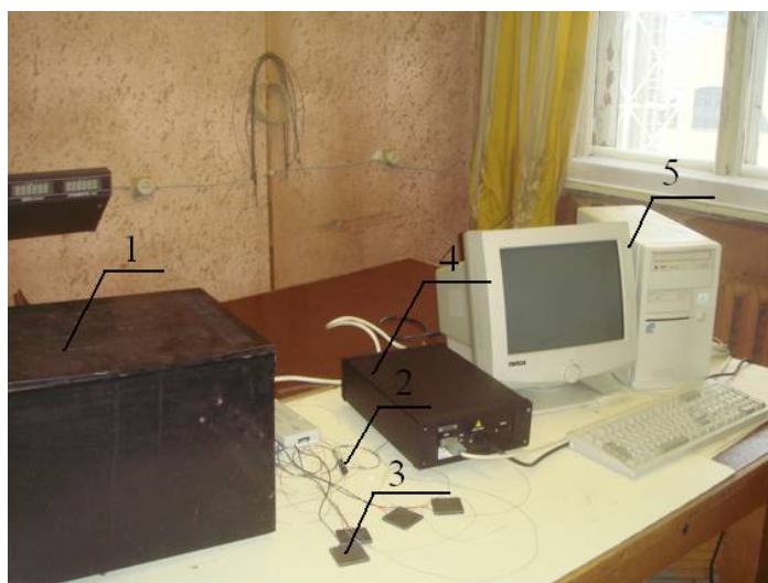
Рис. 1. Экспериментальный стенд для исследования процесса тепловой обработки сосисок инфракрасным излучением.
