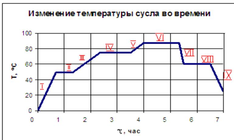
**Рис. 2** Изменение температуры сусла в рабочем объеме КСИБА в процессе водно-тепловой и ферментативной обработки крахмалсодержащего сырья.
