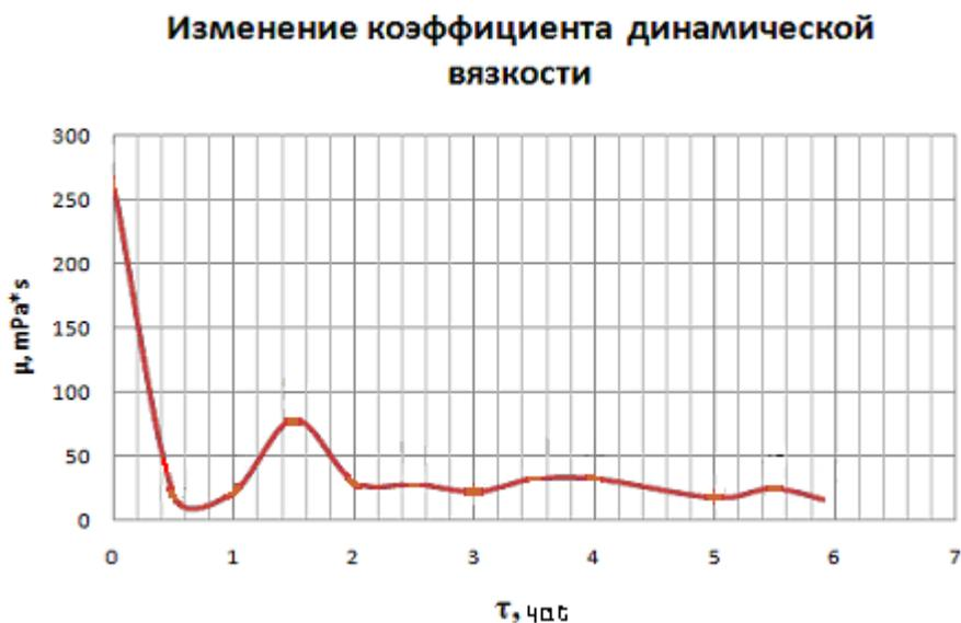
**Рис.4** Изменение коэффициента динамической вязкости суслу в процессе проведения его водно-тепловой обработки
