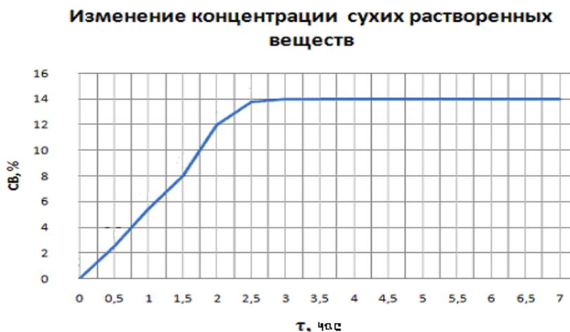
**Рис. 3** Изменение концентрации растворенных сухих веществ в рабочем объеме КСИБА в процессе водно-тепловой и ферментативной обработки крахмалсодержащего сырья.
