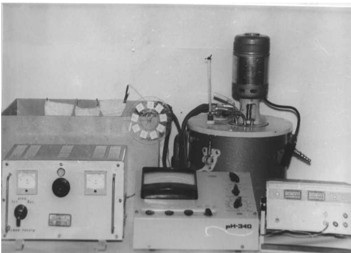
Рис.1. Экспериментальная установка для изготовления рабочих органов методом гальваностегии
