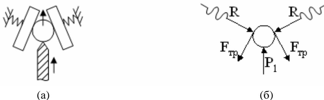
Рис. 1.5. Схема движения инструмента (а) и схема сил (б) при комбинированном виброизломе с истиранием.
