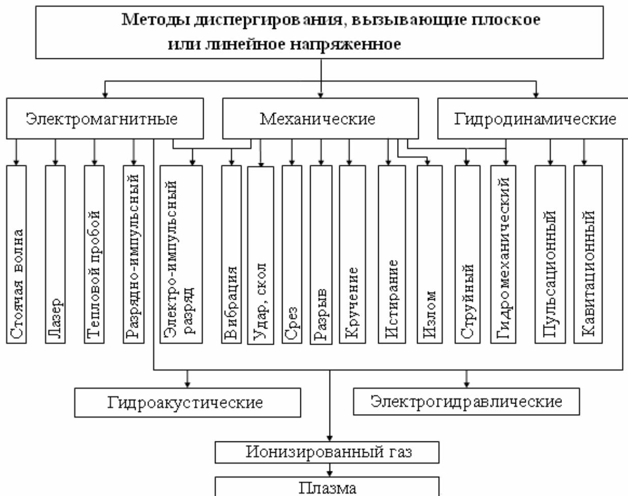
Рис. 1.2. Классификация способов диспергирования материалов по виду напряженного состояния и методам внешнего воздействия.
