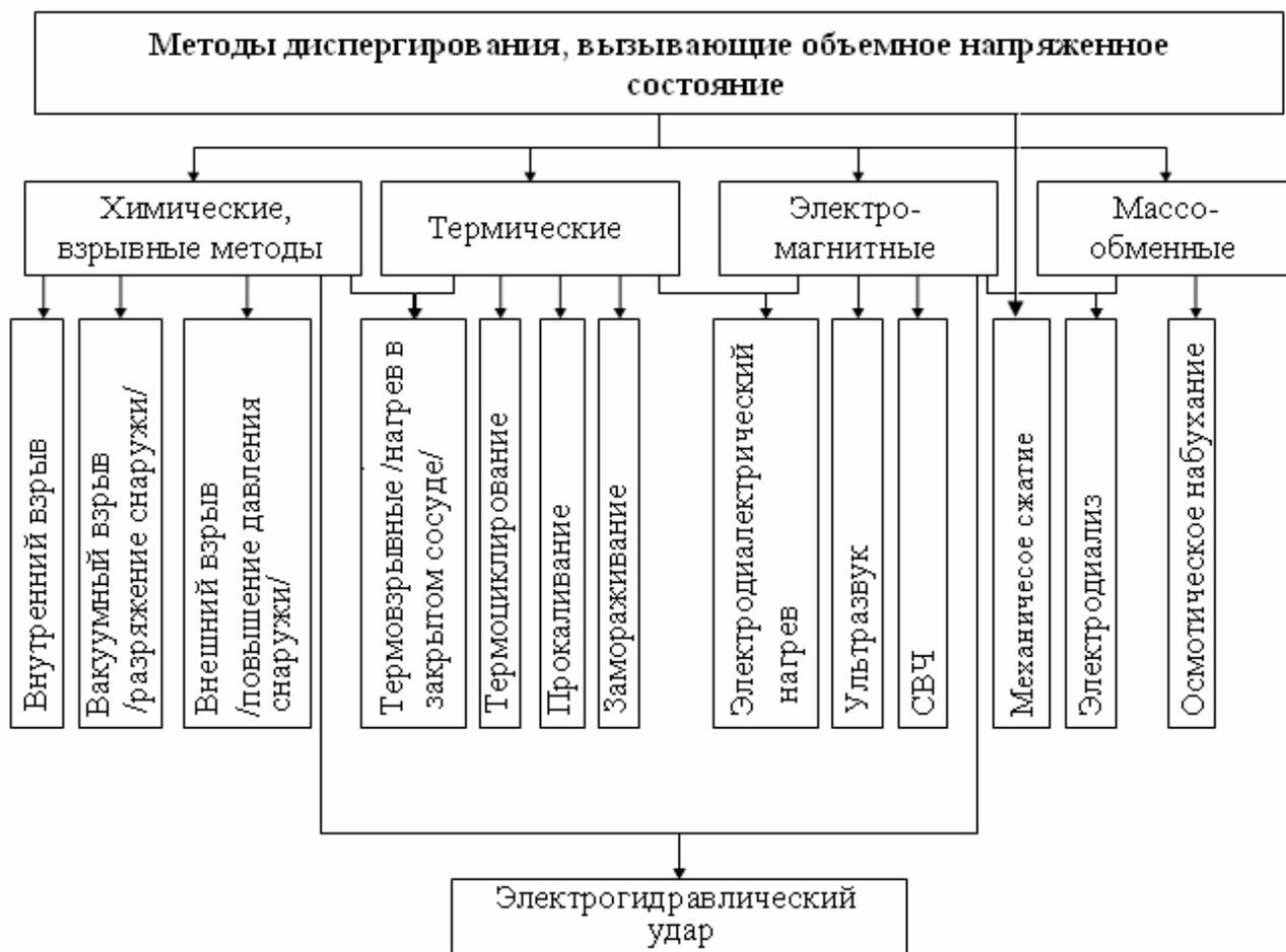
Рис. 1.3. Классификация способов диспергирования материалов по виду напряженного состояния и методам внешнего воздействия.
