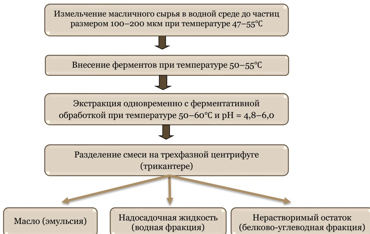
Рисунок – Схема одновременного получения масла и белка из семян масличных по модифицированной технологии, разработанной ВНИИЖиров
