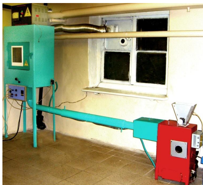
Рисунок 1 – Установка электростатического копчения с индуктивным подводом энергии при дымогенерации в среде инертного газа
