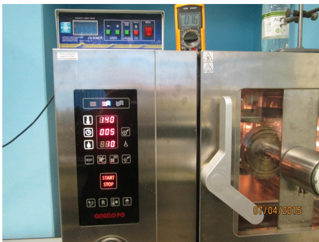
Рисунок 1 – Опытно-промышленная установка на базе пароконвектомата Angelo Po и ультразвукового генератора «Соловей» во время эксперимента
