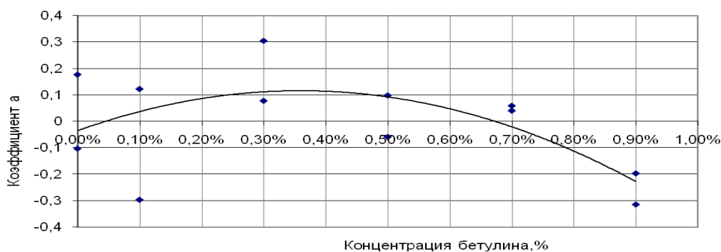
Рис. 5. Зависимость тангенса угла наклона прямых линий тренда (коэффициент a в уравнениях прямых y = ax + b ) в корреляционных зависимостях ординаты максимума распределения яркости от величины рН (пример на рис. 3) от концентрации бетулина, использованной в вареной колбасе
