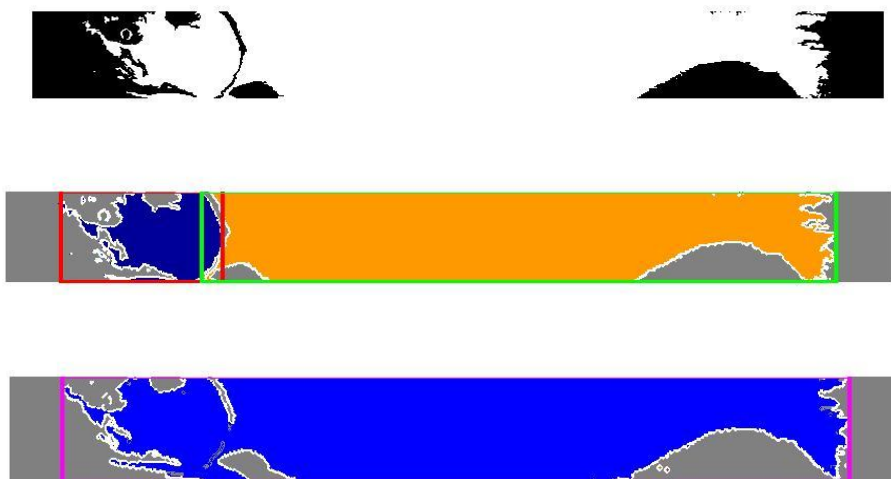
Рис. 4. Изображения тушки рыбы после выборки полосы, инверсии, сегментации, выделения областей, построения многоугольников, содержащих вписанные псевдоцветные изображения головы рыбы и всей тушки
