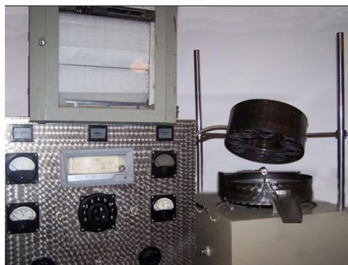
**Рис. 1. Экспериментальная установка для сушки плодовых косточек инфракрасным излучением в виброкипящем слое:**
