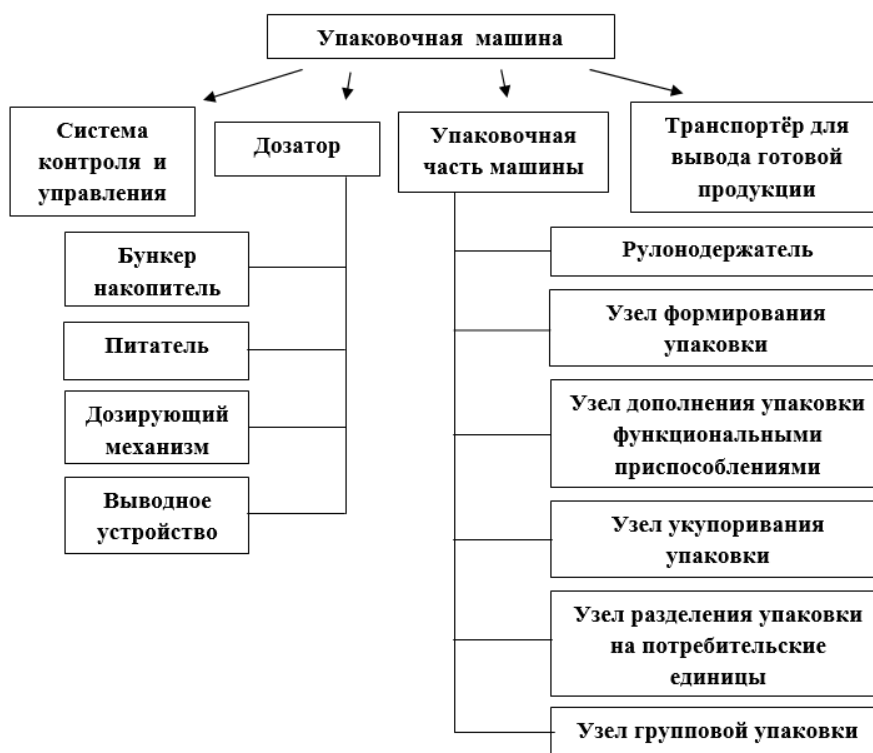
Рис. 1. Структура упаковочной машины
