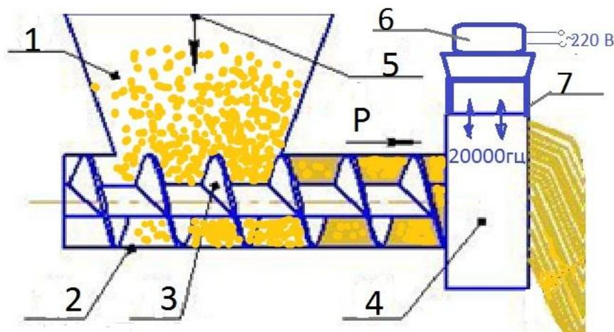
Рис. 1. Схема ультразвукового пресса с радиальным подведением колебаний: 1 –бункер; 2 – шнековая труба; 3 – шнек; 4 – матрица с накладной гайкой; 5-тесто; 6 – магнестрикционный преобразователь; 7 – экспоненциальный ультразвуковой концентратор; P- давление перед фильерами матрицы.
